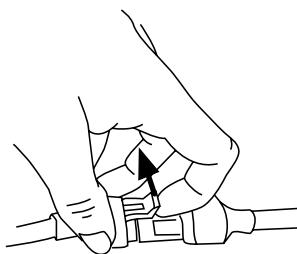
Pour démonter, tirer vers le haut la languette du connecteur.
